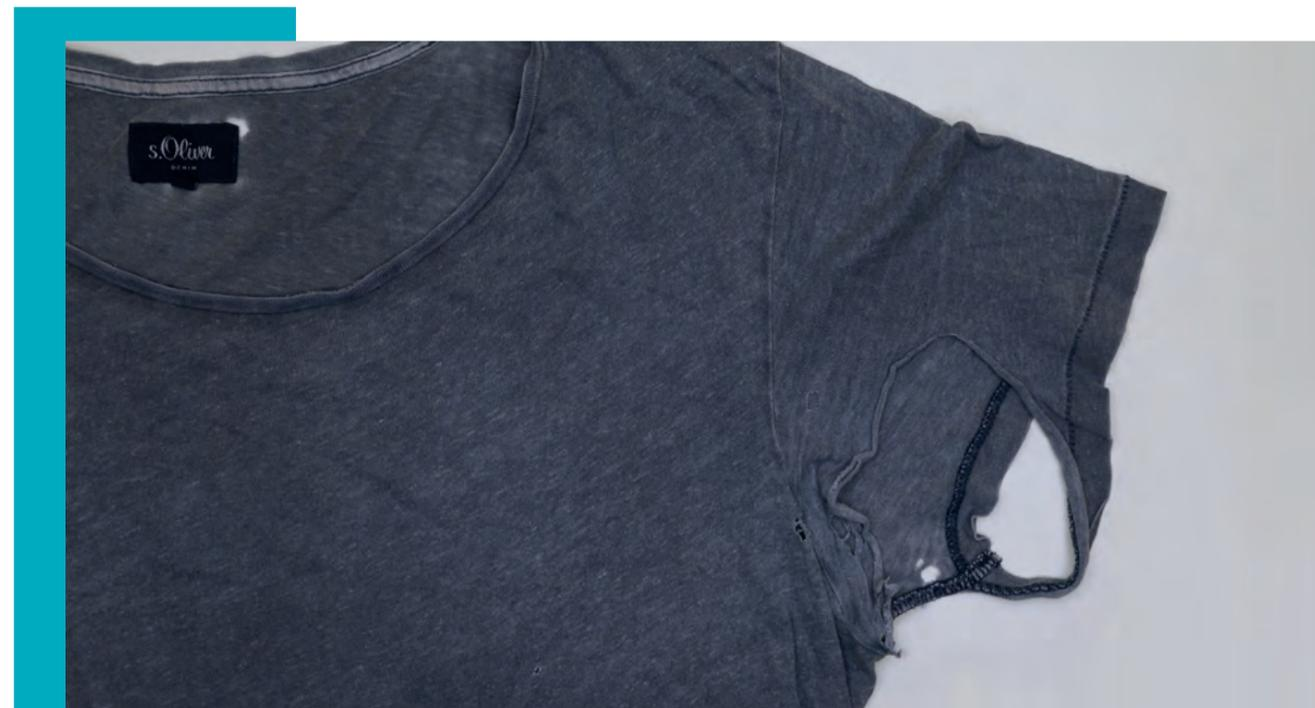
Abbildung 4: Verschleißstellen aufgrund der Stoffqualität und Verarbeitung
