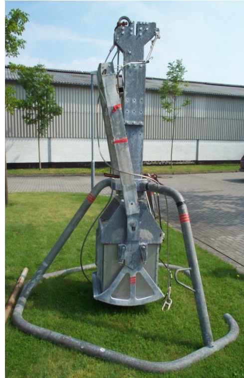
Abbildung 6: Der bei den Probenahmen eingesetzte Großkastengreifer.
