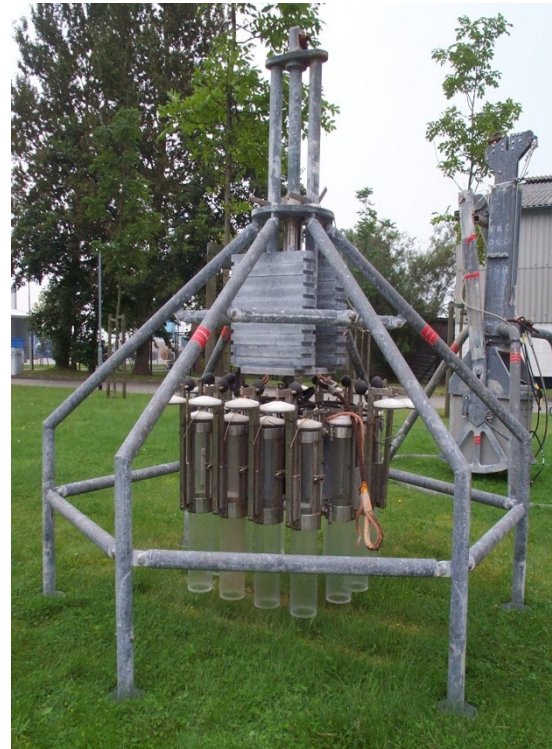
Abbildung 5: Der bei den Probenahmen eingesetzte Multicorer.
