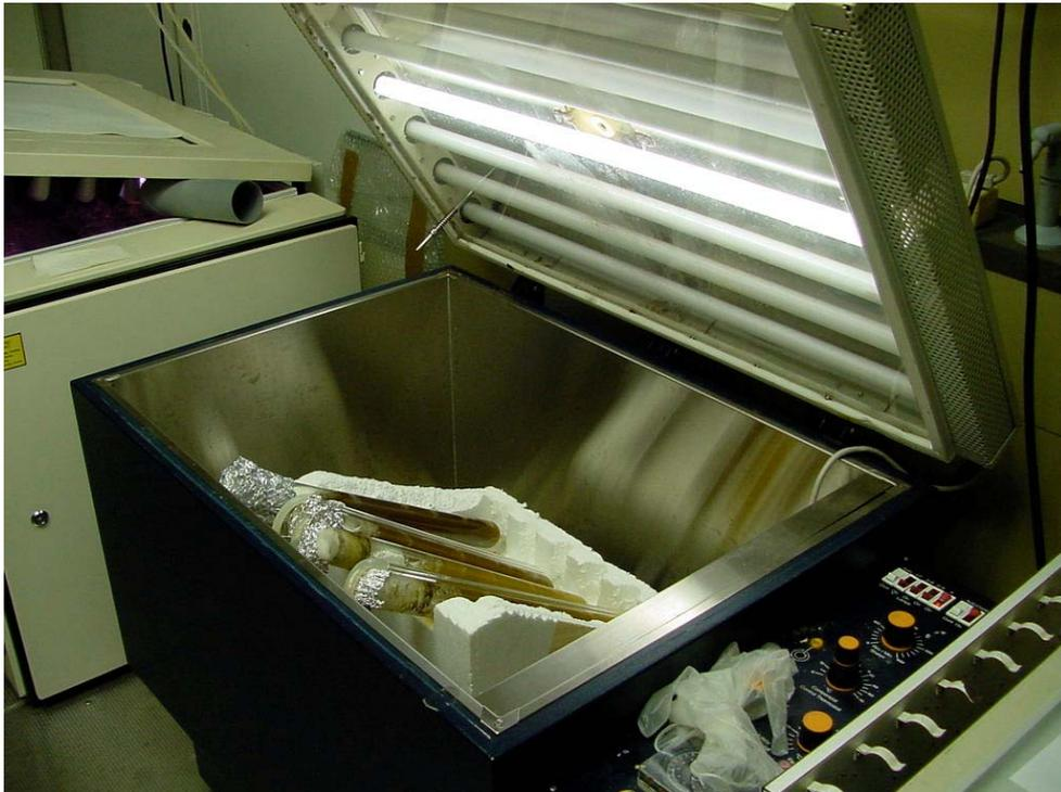
Gallenkamp Orbital Inkubator mit *Cyclotella cryptica* Flüssigkulturen in den Glasröhren
