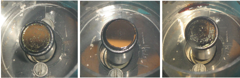
Abbildung A.137.: Spincoating -Resultate der unterschiedlichen Ansätze für die REM-Untersuchungen mit hoher Schichtdicke. Links: \text{NO}_2[\text{Au}(\text{NO}_3)_4] -Precursor, mitte: \text{N}_2\text{O}_5 -Lösung, rechts: \text{NO}[\text{Au}(\text{NO}_3)_4] -Precursor.
