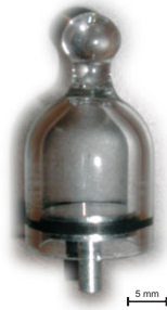
Abbildung 3.13.: REM-Proben-Stempel mit Transportkuppel für den Transfer der Precursor-Proben unter Stickstoffatmosphäre in das Raster-Elektronen-Mikroskop.
