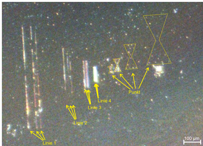
Abbildung 8.11.: Lichtmikroskopische Abbildung des Ergebnisses der Abscheideexperimente nach dem Abspülen des unreaktierten Precursors mit \text{HNO}_3 . Die Positionen bzw. Bereiche der abgeschiedenen Linien und Punkte nach Abb. 8.8 sind gelb markiert. (Bild [215])
