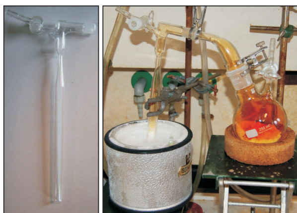
Abbildung 5.21.: Glasampulle ( links ) und ( rechts ) Sublimieren von \text{N}_2\text{O}_5 (im Kolben) auf vorgelegtes Metall in der Glasampulle. [140]
