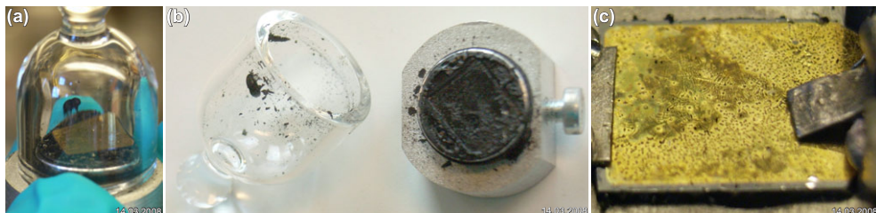
Abbildung A.70.: (a) Probe unter Glaskuppel nach insgesamt 3 Tagen N_2O_5 -Einfluss; (b) REM-Stempel und Glaskuppel nach Demontage der Probe; (c) Makroaufnahme der 130 nm dicke Goldschicht in der Glovebox nach Reaktion mit dem flüssigen N_2O_5 .
