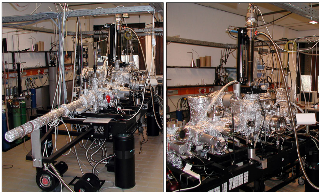
Abbildung 3.1.: XPS/STM-UHV-Kammer. links: Übersicht mit Transferstange, rechts: Übersicht Analysebereich
