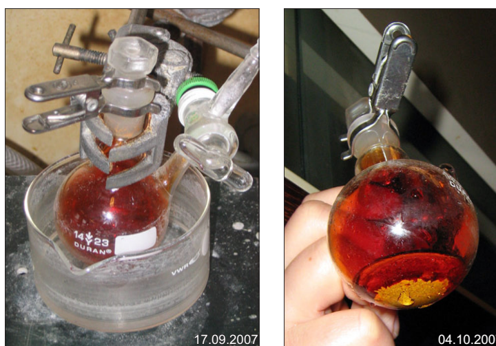
Abbildung 5.17.: Reaktion von \text{N}_2\text{O}_5 mit Gold im Schlenkcolben.
