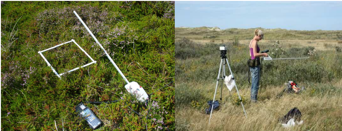
Abb. 3-4: Messung der Vegetationsdichte (Beschattung) auf Borkum. Links: SunScan-Lichtmesser neben Zufallspunkt (10.08.2009). Rechts: Messung mit SunScan-Lichtmesser und frei exponiertem BF2 Sunshine Sensor (Foto: N. OBERDIEK, 14.08.2009).
