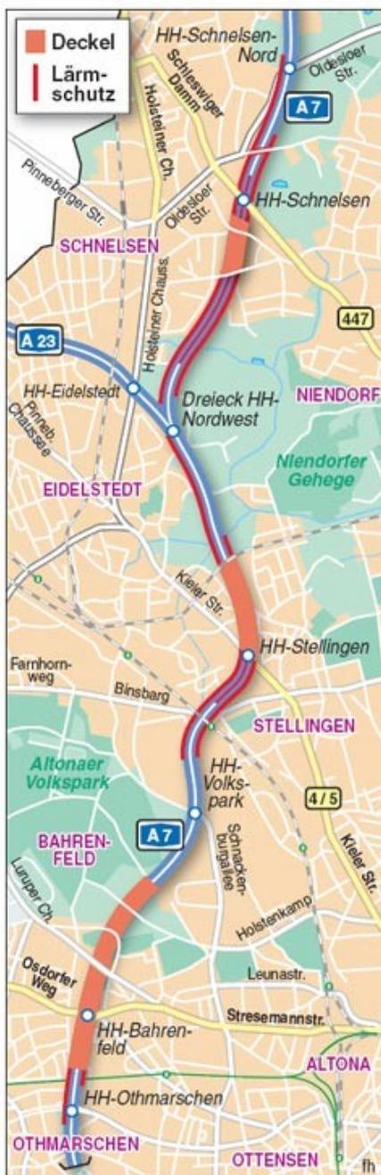
Abbildung 16: Über die Autobahn 7 sollen auf Hamburger Stadtgebiet drei Deckel gebaut werden (rote Flächen). Zwischen den Deckeln werden Lärmschutzwände (rote Linien) errichtet. [Hamburger Abendblatt, Hasse, 2009]
