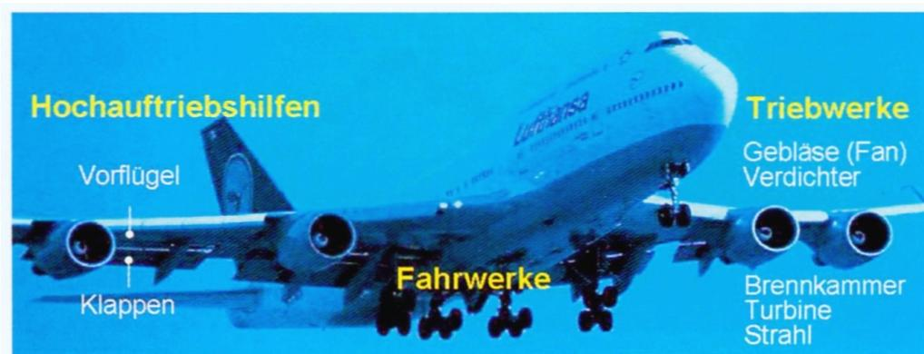
Abbildung 6: Schallquellen am Flugzeug [Leben mit Lärm, M. Kloepfer, 2006]
