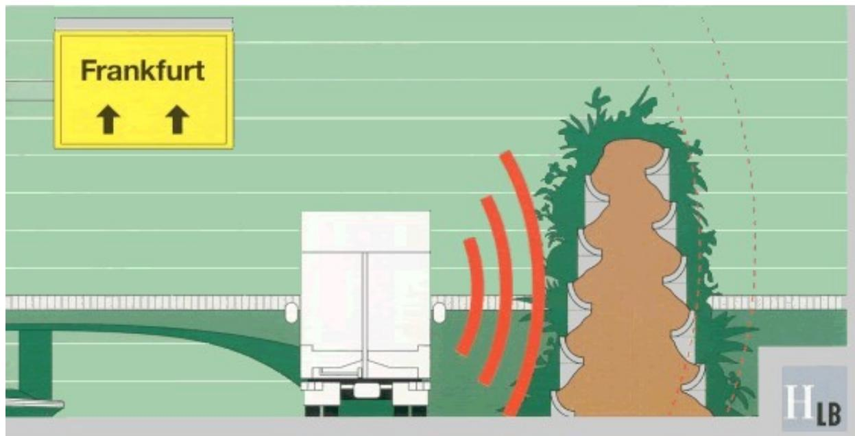
Abbildung 15: Steilwall von Greenwall® System (<http://www.hlb-gmbh.de/greenwall.htm>)
