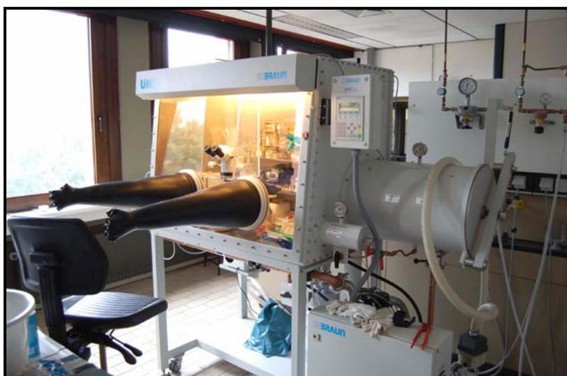
**Abb. 1:** Stickstoff-Handschuhbox „Unilab“ der Firma M. BRAUN.
