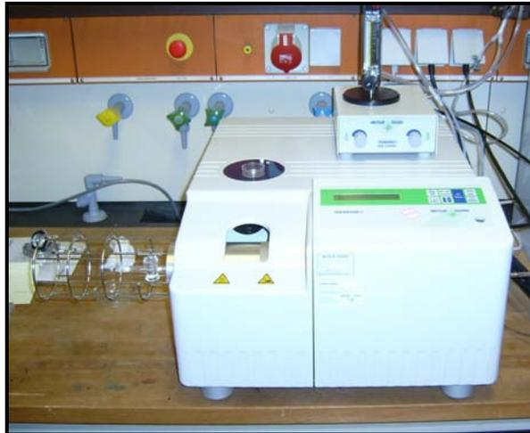
**Abb. 7:** SDTA/TG-Apparatur.
