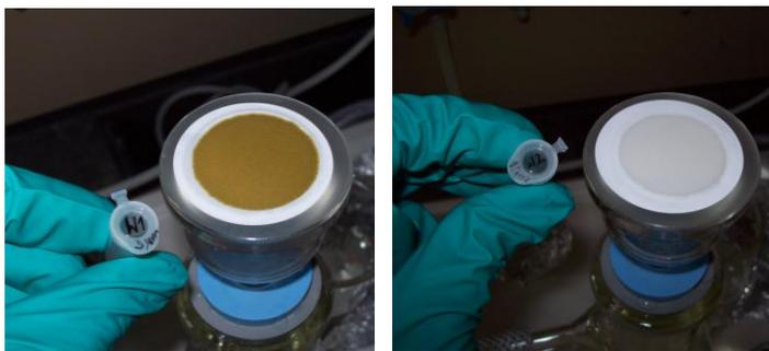
Abb. 46: Filtermembranen nach Filtrierung von 400 ml Probenwasser (PW OT). Filter linke Seite: 3 µm Porenweite, Filter rechtes Bild: 1 µm Porenweite. Probenwasser war über Papierfilter vorgefiltert worden.
