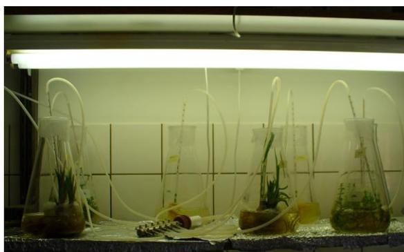
Abb. 6: Aufbau mit Probengläsern der Inkubationsansätze von *Iris pseudacorus* (links, Mitte) und *Mentha aquatica* (rechts) und zwei Nullkontrollen im Hintergrund.
