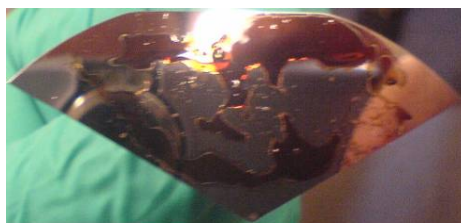
Abb. 61: Si-Wafer nach dem Spülvorgang mit \text{HNO}_3
