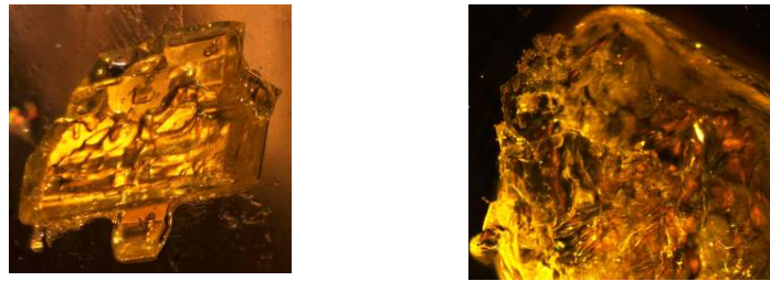
Abb. 24: Kristalle von (\text{NO})[\text{Au}(\text{NO}_3)_4] unter dem Lichtmikroskop
