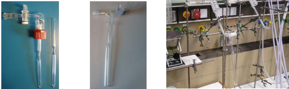
Abb. 3: Glasampulle mit Quickfit (links), Glasampulle mit Hahn und Schliff (Mitte), Glasampulle an der Abschmelzapparatur
