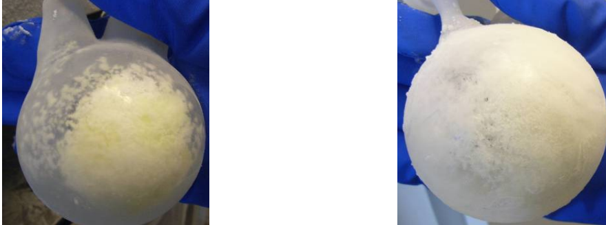
Abb. 18: Verunreinigtes \text{N}_2\text{O}_5 (Synthese mit \text{O}_2 (links)) und reines \text{N}_2\text{O}_5 (Synthese mit \text{O}_3 (rechts))
