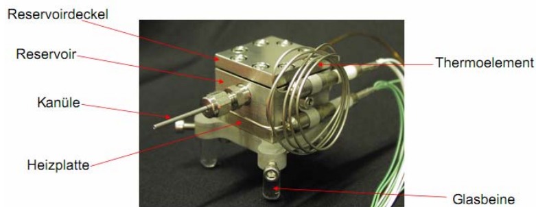
Abb. 45: Miniatursteuerroboter mit Verdampfungsanlage zum Einbau in die Vakuumkammer des Rasterelektronenmikroskops
