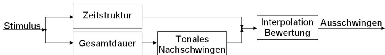
Abbildung 4.14: Blockschaltbild des Algorithmus für die Nachbildung des Faktors Ausschwingen beim Öffnungsgeräusch
