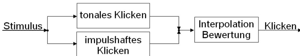
**Abbildung 4.23:** Blockschaltbild des Algorithmus zum Klickfaktor beim Öffnungsgeräusch
