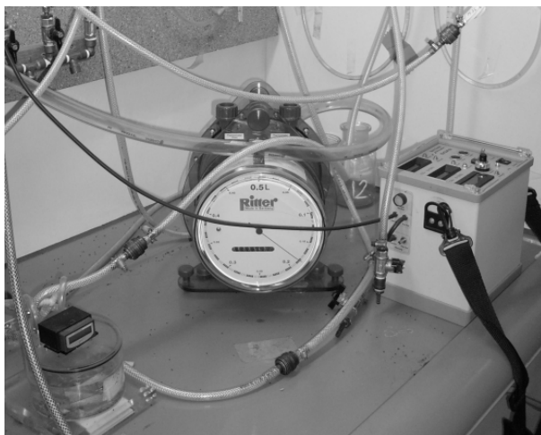
Abbildung 13: Milligaszähler, Trommelgaszähler und Gasanalysegerät am Messplatz II (M. Röhrdanz).
