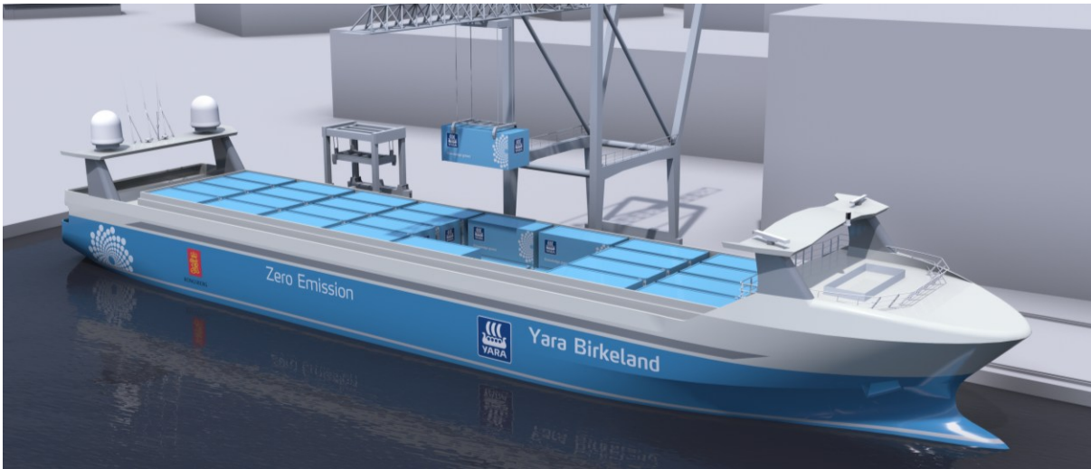
Abbildung 5: Computergrafische 3D Illustration des Containerschiffes Yara Birkeland, welches zukünftig vollständig automatisiert und ohne Personal an Bord zwischen dem Herøya-Industriepark und den Häfen Brevik und Larvik verkehren soll. [Yara International ASA, 2022]
