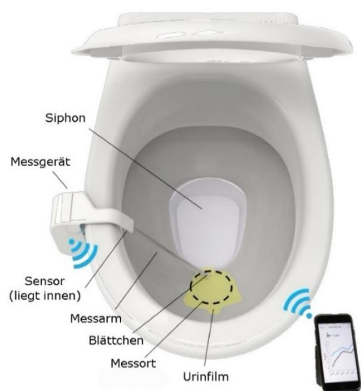
Abbildung 5: Exemplarische Anbringung des Messgeräts
