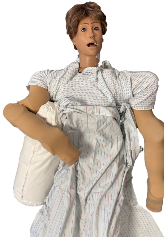
Abbildung 7.1: Androide Roboter-Patientin mit zwei Roboterarmen (ReBeL Cobot mit sechs „Degree of Freedom“). Die neuen Roboterarme sind direkt am Körper der androiden Roboter-Patientin befestigt.
