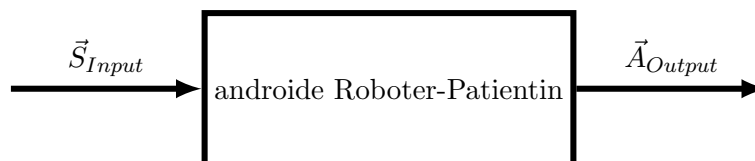
Abbildung 5.13: Schematische Darstellung des Interaktionsmodus. Sensorisch erfasste Reize können dem Inputraum \vec{S}_{Input} der androiden Roboter-Patientin zugeordnet werden. Die erfassten Reize werden im Anschluss von der androiden Roboter-Patientin verarbeitet und führen über den Outputraum \vec{A}_{Output} zu einer Reaktion, die potentiell von einer interagierenden Person wahrgenommen werden kann.
