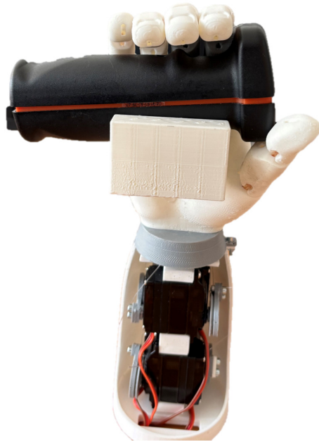
(a) Die rechte Hand der androiden Roboter-Patientin für die Messung der Handkraft in der frontalen Ansicht mit einem Handkraftmessgerät (KForce Grip hand isometric dynamometer).
