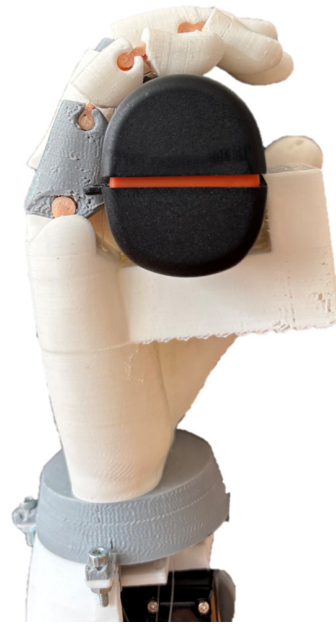
(b) Die rechte Hand der androiden Roboter-Patientin für die Messung der Handkraft in der seitlichen Ansicht mit einem Handkraftmessgerät (KForce Grip hand isometric dynamometer).
