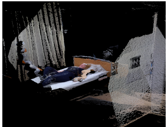
(d) Zusammengefügte Punktwolke (KUKA LBR iiwa 7 R800 und Schauspielpatientin).
