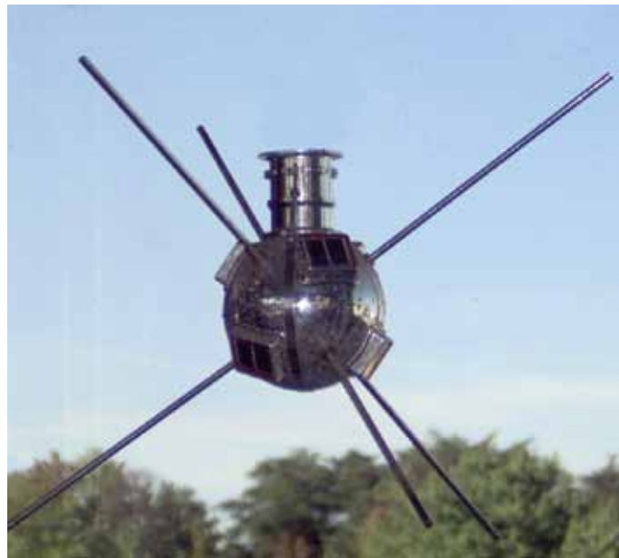
Abb. 4 Vanguard 1, Stromversorgung durch Solarzellen.
