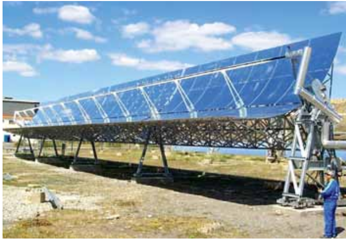
Abb. 16 Bild eines Teststrangs für das Solarfeld eines Parabolrinnenkraftwerk: In der Forschung versucht man die sogenannte solare Direktverdampfung zu realisieren, d.h. auf das Thermoöl zu verzichten und das Wasser schon im Receiver zu verdampfen. Bild mit freundlicher Genehmigung des FVEE und des DLR.
