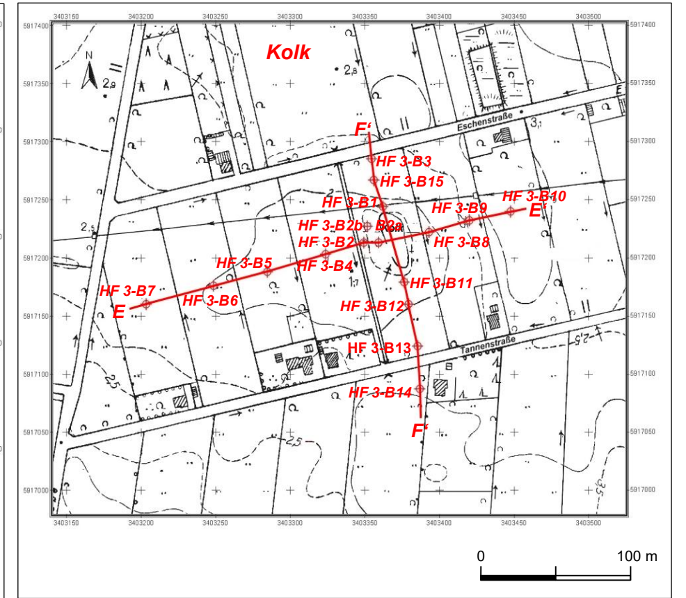
Abbildung 7-3. Kreuzprofil Kolk mit abgeteufte Bohrungen HF3-B1 bis HF3-B15, Blatt 2611/08 Westgroßefehn
