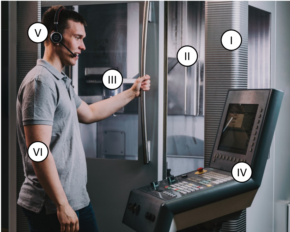
Abbildung 17: Sprachsteuerung einer Werkzeugmaschine als Ergänzung zu einem konventionellen, haptisch-visuellen HMI (I. 5-Achs Fräsmaschine, II. Prozesskammer, III. Frässpindel mit eingespanntem Werkzeug, IV. haptisch-visuelles HMI mit Bildschirm, Tastaturen, Schaltern, Drehreglern und Tastern, V. Over-Ear-Headset (Hearpiece), VI. Proband) ©Fraunhofer IDMT 2022 / Anika Bödecker
