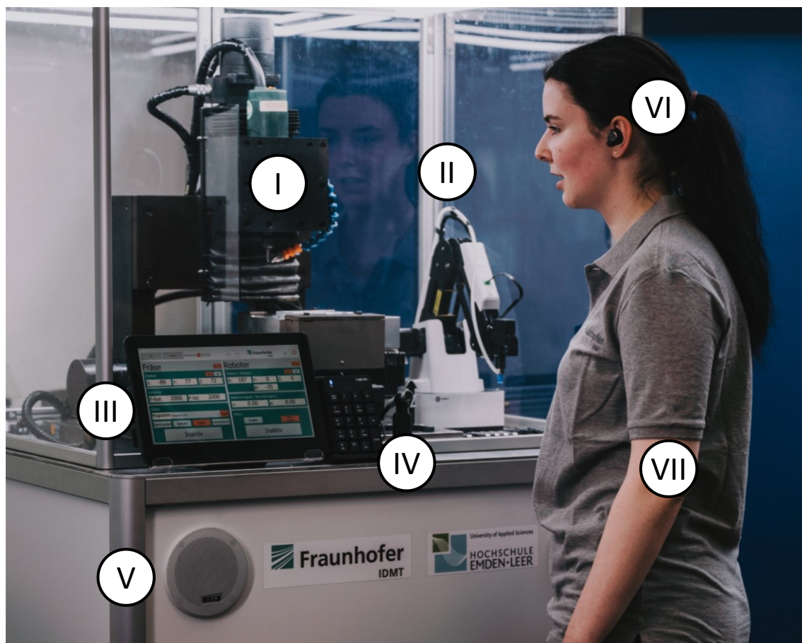
Abbildung 21: Interaktion der Probanden mit der »VCP-Technologieplattform I« innerhalb der Forschungsstudie (I. 3-Achs Fräsmaschine, II. 4-Achs Roboter, III. Touchscreen, IV. Omnidirektionales Mikrofon, V. Lautsprecher, VI. In-Ear-Headset (Hearpiece), VII. Probandin) [NER23] © 2023 IEEE
