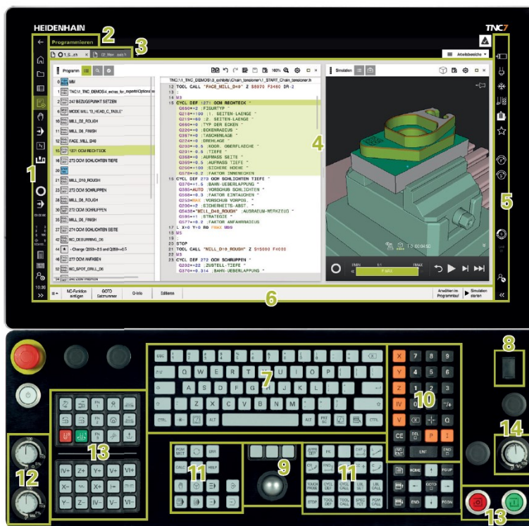
Abbildung 5: Detailansicht des Human-Machine Interface einer Heidenhain TNC7 Steuerung eines 5-Achs-Fräsbearbeitungszentrums [Hei24]
