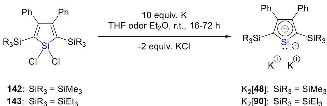
Schema 7. Reduktion der 2,5-silylsubstituierten 1,1-Dichlorsilole 142 und 143 zu den entsprechenden Dikaliumsiloldiiden K 2 [ 48 ] und K 2 [ 90 ] in THF oder Et 2 O. [155]
