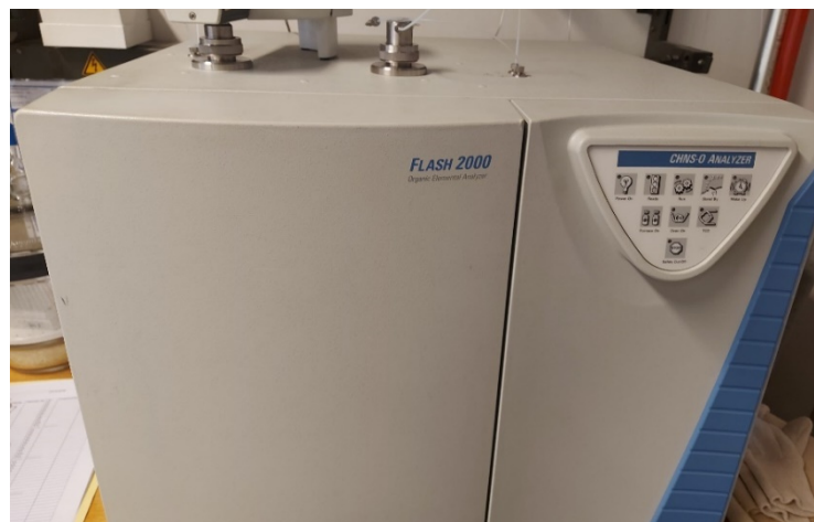
Abbildung 13: Der für die Ermittlung der C- und N-Gehälter verwendete Flash 2000 C/N Analysator der Firma Thermofisher Scientific (Bild: Daniel Buller, 2023).
