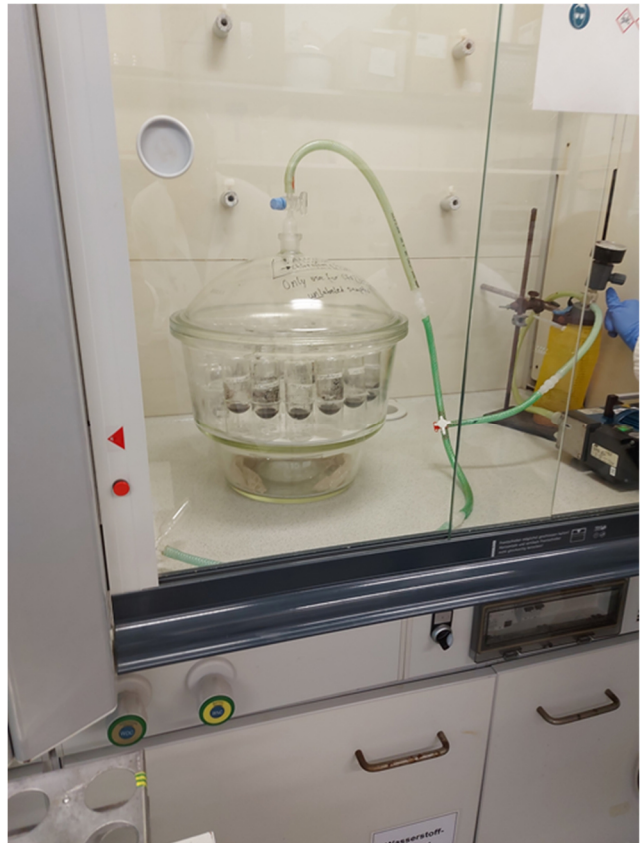
Abbildung 9: Vor der Extraktion des mikrobiellen Kohlenstoffs und Stickstoffs wurden die Bodenproben in einen Exsikkator platziert, in dem sie über einen Zeitraum von 48 Stunden mit Chloroform begast wurden (Bild: Daniel Buller, 2023).
