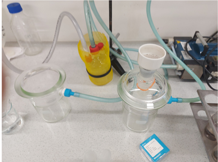
Abbildung 10: Aufbau der Entgasungsanlage, an der die Extraktion des mikrobielle Kohlenstoffs und Stickstoffs erfolgte (Bild: Daniel Buller, 2023).
