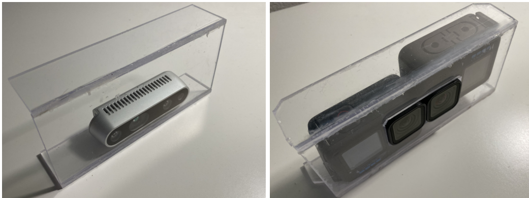
(a) Intel® RealSense™ Kamera D435 im Plexiglasgehäuse
