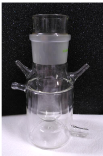
Abbildung 22: Photo des verwendeten Reaktors zur Bestimmung der Aktivität hinsichtlich der Wasserstoffproduktion.
