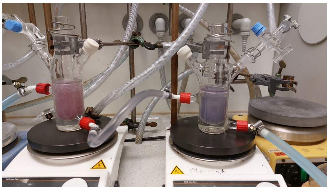
Abbildung 48: Reaktoraufbau mit dem Vergleich der Reaktionslösungen mit DIPEA (links) und ohne DIPEA (rechts) nach 19.5 h Beleuchtung mit weißem Licht.
