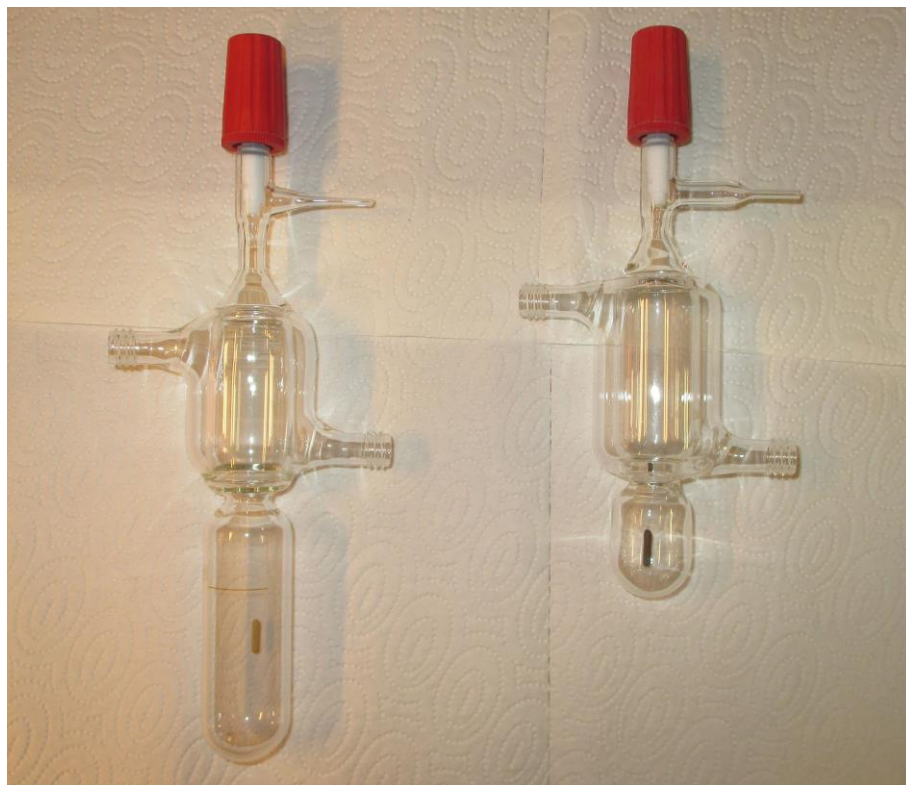
Abbildung 10: Schlenkrohre mit integrierter aktiver Kühlung.
