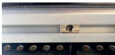
Abbildung 38: Verstellbare Gewindeplatte am Förderband
