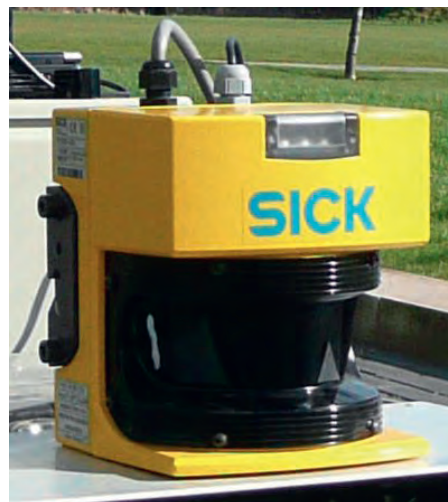
Abbildung 7: Ein Lidar in einem mobilen Roboter von der Firma SICK 1
