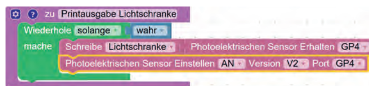
Abbildung 42: Einschalten der Lichtschanke
