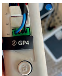
Abbildung 40: Anschluss Lichtschanke DOBOT
