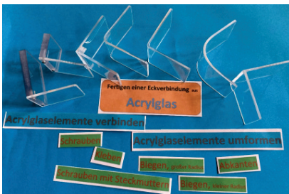
Abbildung 12 Möglichkeiten der Herstellung von Eckverbindungen aus Acrylglas
