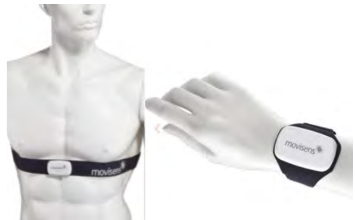
Abb. 1. Validierte Bewegungssensoren an Modellen. Links: Sensor im Brustgurt, rechts: Bewegungssensor am Handgelenk. (Quelle: movisens)
