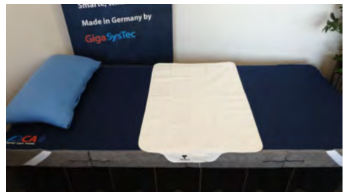
Abb. 2. Textilbasierte Sensormatte zur Erfassung der Bewegungen im Bett. (Quelle: GigaSysTech)
