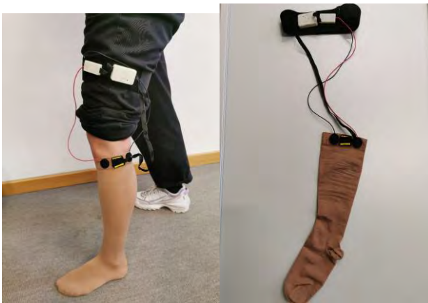
Abb. 1. i-compression System inkl. Strumpf mit eingenähten Elektroden und Bewegungssensor, Strumpfband mit technischen Komponenten (Akku, Verarbeitungseinheit, Ein- und Ausschalter mit LEDs, TENS-Einheit)
