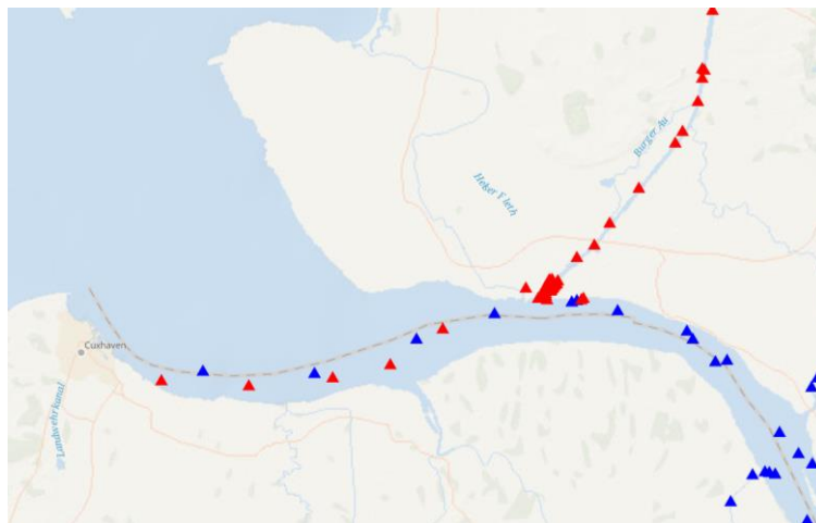
Abbildung 53: Live-Prädiktion von Navigationsentscheidungen für Schiffe im überwachten Bereich des eMIR-Testfeldes in Elbe und Nord-Ostsee-Kanal (Kartendaten: ArcGIS).
