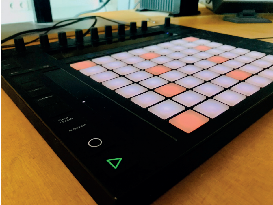
Abb. 1: Die 8×8-Pad-Matrix von Abletons Push-Controller.
