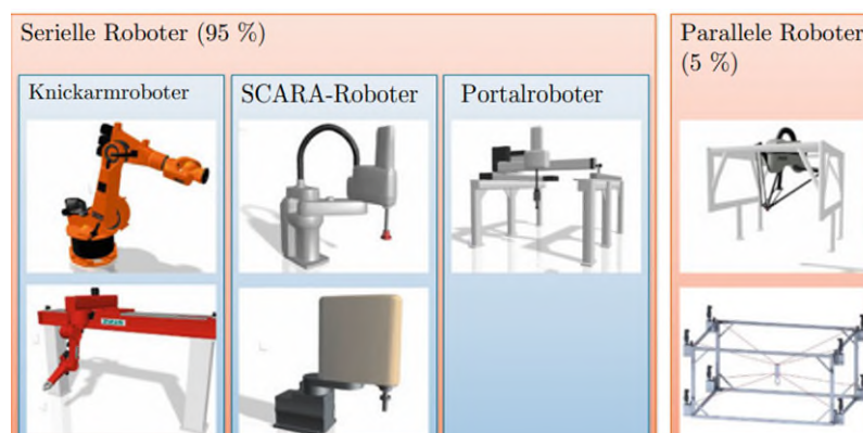
Abbildung 4: Kategorisierung hinsichtlich der Roboterkinematik in serielle und parallele Roboter. Quelle: Pott, Dietz, 2019, S.
