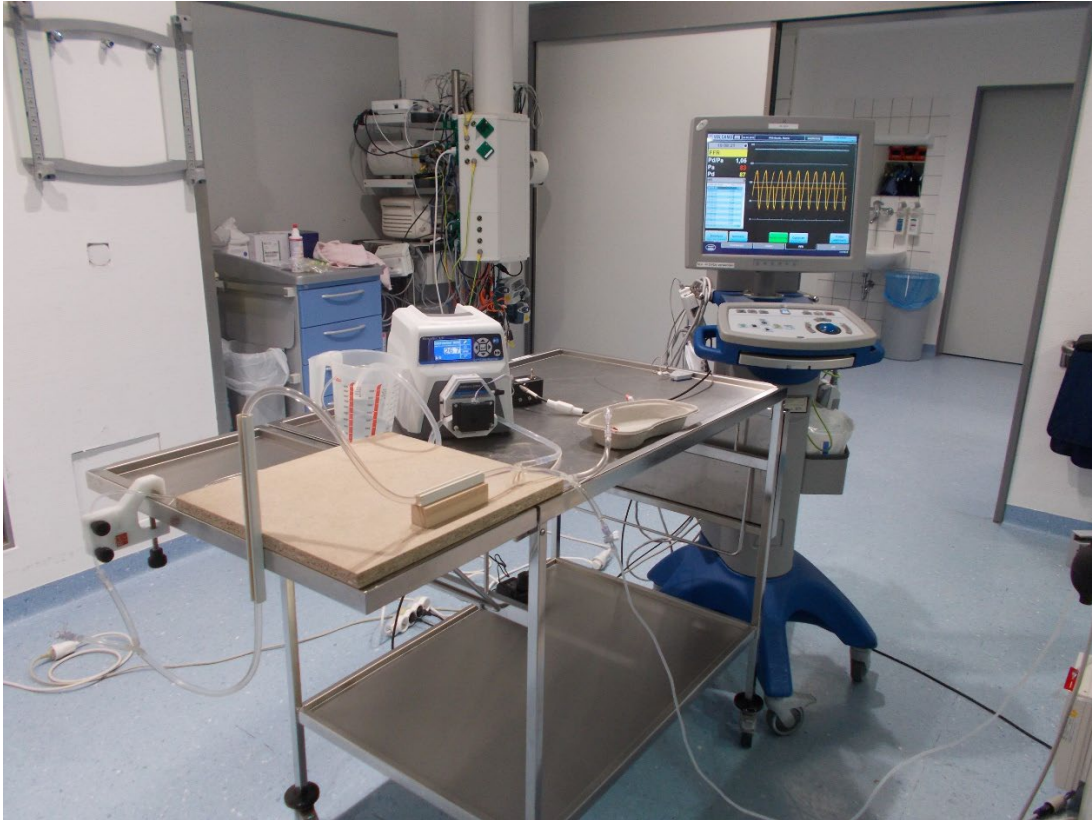
Abbildung 3: Aufbau des in-vitro Modells im Herzkatheterlabor
