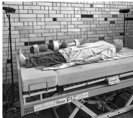
Abb. 1: Aufbau des Aufnahmeszenarios mit Leichtbauroboter, Pflegebett und 3D-Tiefenkamera-System.
