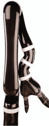
Abbildung 4.3: Der Jaco Roboterarm. Innerhalb einer Studie von Maheu et al., die der Evaluation zum Einsatz bei Rollstuhlfahrern dient, wird der Roboterarm gesteuert, um alltägliche Gegenstände zu greifen [MAFR11] © 2011 IEEE.
