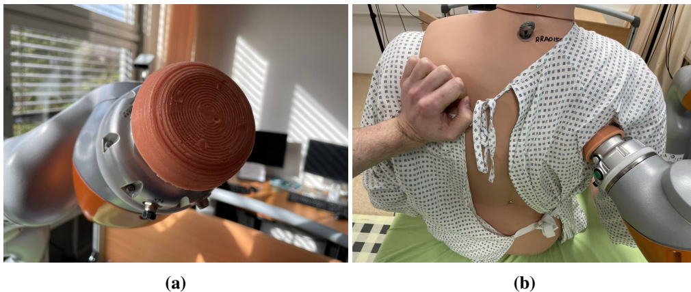
Abbildung 6.23: Das Werkzeug, welches einem Handballen nachempfunden ist (a). In Abbildung (b) drückt der Roboter unter Nutzung des Werkzeugs gemeinsam mit einer Person den Patientensimulator in den Sitz.
