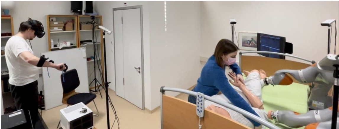
Abbildung 7.16: Ein Roboterarm stellt das Bein des Patientensimulators auf und fixiert dieses. Somit hat die Person am Pflegebett beide Hände frei und braucht das Bein nicht selbst zu stabilisieren.
