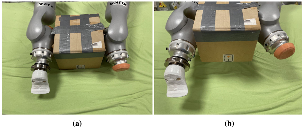
Abbildung 7.18: Eine Pappkiste wird eingeklemmt und angehoben. Neben den Werkzeugen können auch andere Teile des Roboters genutzt werden um Objekte zu berühren oder zu bewegen.
