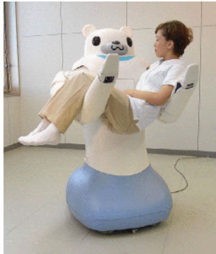
Abbildung 4.5: Der Roboter RIBA trägt einen Menschen in seinen Armen [MHN + 10] © 2010 IEEE.
