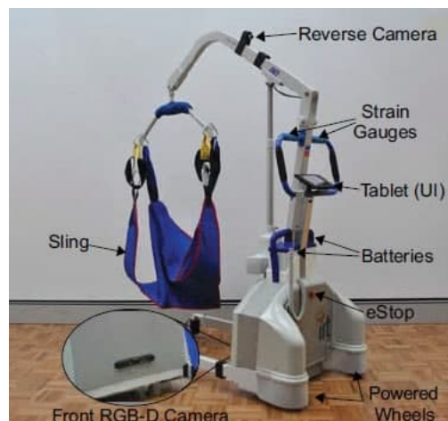
Abbildung 4.4: Das Gerät Smart Hoist , mit dem Patiententransfers für Pfleger erleichtert werden sollen. Der umfunktionierte Patientenlifter ist mit mehreren Sensoren und Aktoren ausgestattet. Die Griffe ermöglichen eine Steuerung des Geräts über Dehnungsmessstreifen (Front RGB-D Camera: Vordere Farb- und Tiefenbildkamera, Sling: Trage, Reverse Camera: Rückwärtskamera, Strain Gauges: Dehnungsmessstreifen, Tablet (UI): Tablet (Nutzerinterface), Batteries: Batterien, eStop: Notaus, Powered Wheels: Angetriebene Räder) [RDT + 14] © 2014 IEEE.
