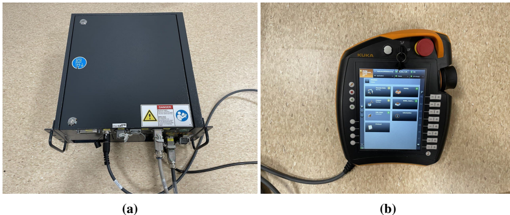
Abbildung 6.16: Die zusätzliche Hardware, zum Betrieb eines Kuka LBR iiwa 7 R800 . Das Cabinet (a) ist über zwei Anschlüsse mit dem Roboter und einem Anschluss mit dem Smartpad (b) verbunden. Über einen herkömmlichen Anschluss über Schutzkontaktsteckdose wird das Cabinet an das Stromnetz angeschlossen.
