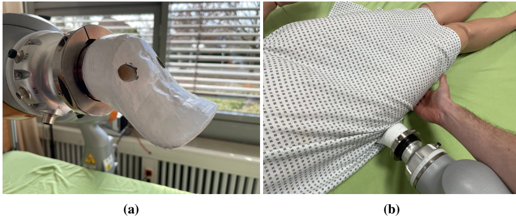
Abbildung 6.22: Das Werkzeug, welches einer halb geöffneten menschlichen Hand nachempfunden ist (a). In Abbildung (b) wird das Werkzeug unter den Oberschenkel des Patientensimulators geschoben.
