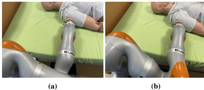
Abbildung 6.33: Unterschiedliche Gelenkpositionen führen zu gleichem Ergebnis, sofern das Mapping nur in der Nähe des Endeffektors stattfindet. Das Ergebnis der Ausrichtung des Roboterarms, hinsichtlich der Position von Link 5 und des Endeffektors, ist in (a) und (b) nahezu identisch. Die Gelenkpositionen unterscheiden sich jedoch für die Gelenke, die nah an der Roboterbasis sind, erheblich. Dies kann an der Position des orangefarbenen Gelenks gesehen werden.
