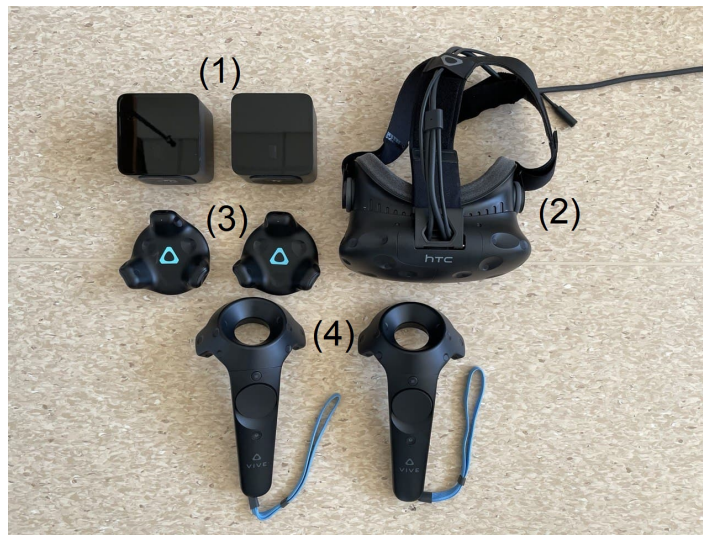
Abbildung 6.25: Das HTC Vive -VR-System, welches in dieser Arbeit zum Einsatz kommt. Es besteht aus den zwei Basistationen Lighthouse (1), dem HMD (2) und den beiden VR-Controllern (4). Zusätzlich werden die beiden VR-Tracker (3) eingesetzt.
