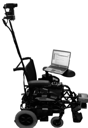
Abbildung 4.2: Der Roboterrollstuhl sena . Ein kommerzieller Rollstuhl ist mit Sensorik und Aktorik ausgestattet, welche über einen Microcontroller mit einem Laptop kommunizieren [GGF06] © 2006 IEEE.
