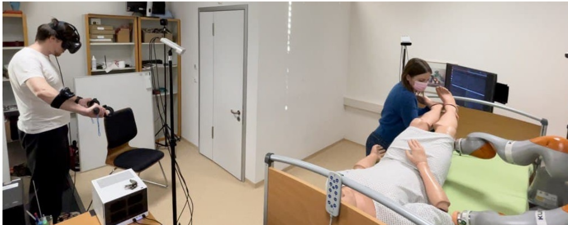
Abbildung 7.17: Ein ferngesteuerter Roboterarm des Gesamtsystems unterstützt bei der simulierten Mobilisierung der Beine des Patientensimulators.
