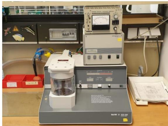
Abbildung 39: *Sputter Coater Bal-Tec SCD 005* der Elektronenmikroskopie an der *Universität Oldenburg*.
