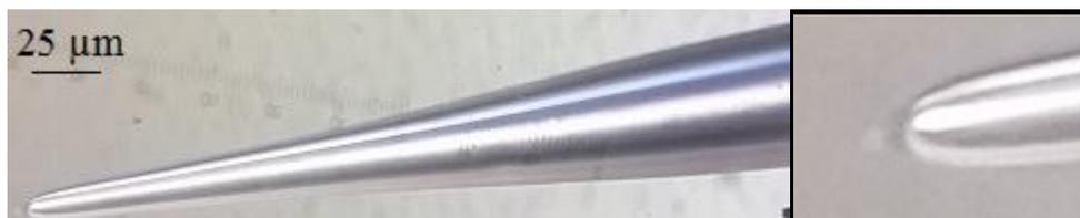
Abbildung 3.20: Links: Fertige Spitze, wie sie später verwendet wurde. Rechts: Apex der Spitze. Auf der Kugel ist die kleine Mikrospitze zu sehen.
