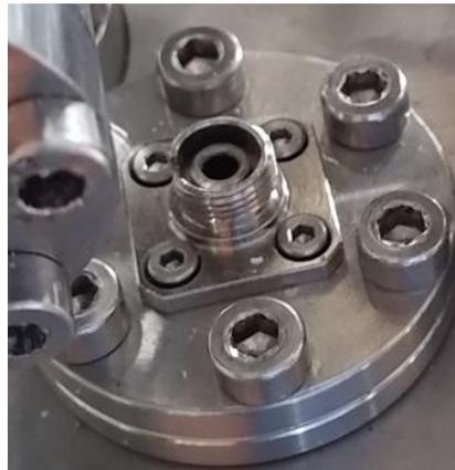
Abbildung 3.38: 16er Flansch mit Faseraufsatz für eine Glasfaser mit FC
