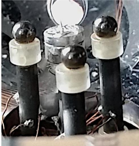
Abbildung 3.27: Spitze in Spitzenhalter eingeklebt und aufgesetzt auf den Neodymmagneten des Spitzenpiezos.
