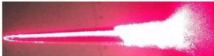
Abbildung 3.31: Eingekoppelter Laser in Glasfaser. Viele Stellen sind zu sehen, an denen das Licht des Lasers austritt
