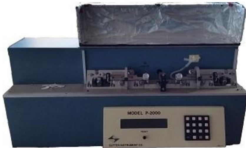
Abbildung 3.14: Verwendeter Pipettenzieher der Firma Sutter-Instruments
