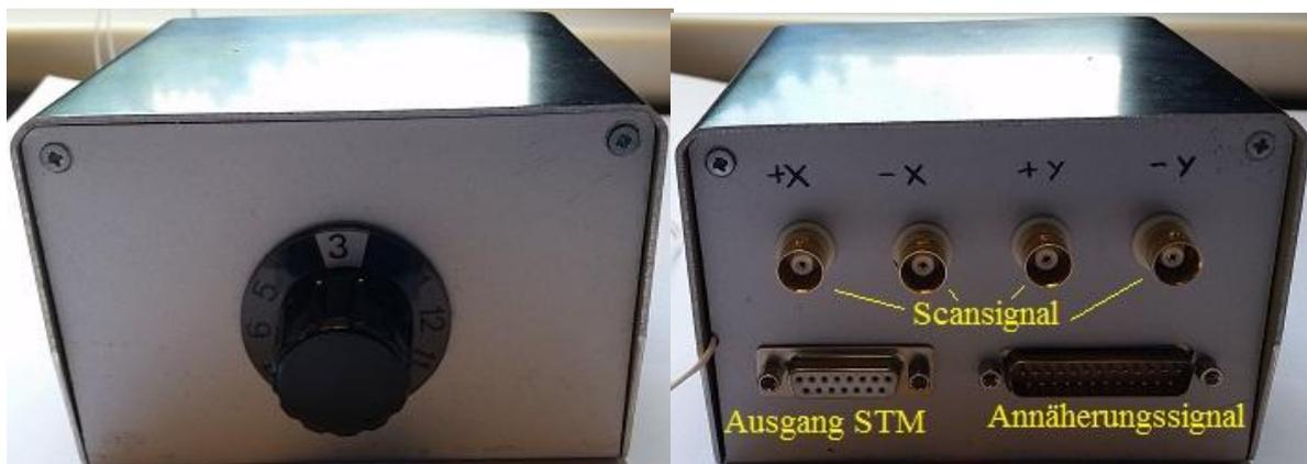
Abbildung 3.10: Links: Schalterbox von vorne. Rechts Schalterbox von Hinten mit den Anschlüssen für die vier Scanrichtungen, den SUB-D 25 für das Annäherungssignal und SUB-D 15 als Ausgang zum STM .
