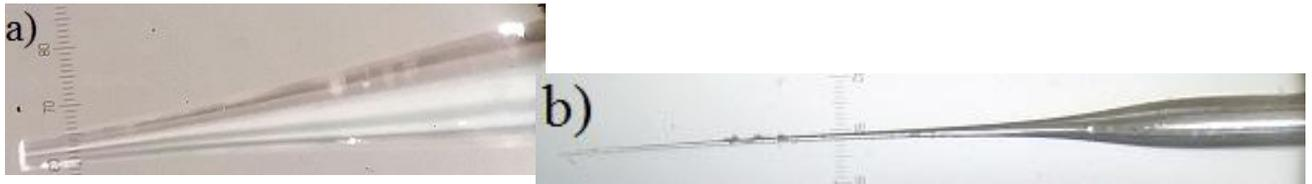
Abbildung 3.17: a) Abgerissene Spitze, die mit zu viel Kraft gezogen wurde b) Zu lange Spitze, die mit einer zu hohen Geschwindigkeit gezogen wurde
