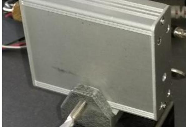
Abbildung 3.43: Photomultiplier von Hamamatsu geschützt in einer Metallbox
