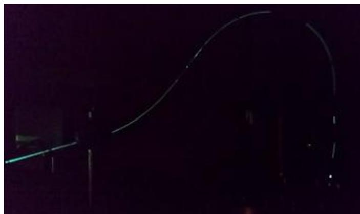
Abbildung 3.39: Superkontinuum Laser in Glasfaser: Die Einkopplung erfolgt auf der linken Seite außerhalb des Bilds, während das Licht an der rechten unteren Ecke im STM verschwindet.
