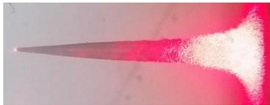
Abbildung 3.30: Glasfaser mit eingekoppelten Laser.
