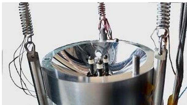
Abbildung 3.40: Hohlspiegel, welcher sich um den Scankopf des Mikroskops befindet.
