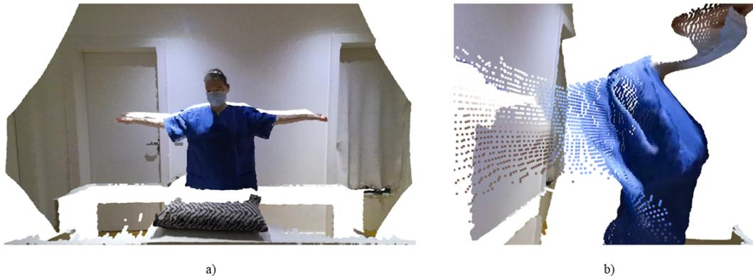
Abb. 2.1: Punktwolken [Quelle: eigene Aufnahme]: a) die Punktwolke in der Frontalansicht, b) die Punktwolke, in der die einzelnen Messpunkte zu sehen sind, in der Seitenansicht
