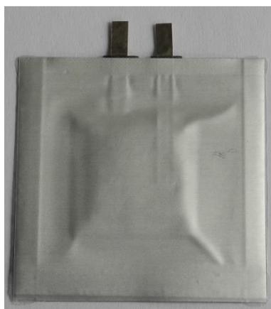
**Abbildung 10: Pouch-Zelle, Kantenlänge 6 cm mal 6 cm.**
