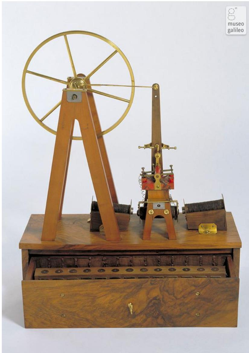
Abbildung 4 Der Elektromotor von Botto mit einer Leistung von einem 1/25 PS. Die Bewegung wird durch das Hin- und Herpendeln des Schenkels auf der rechten Seite auf den Kurbeltrieb übertragen.
