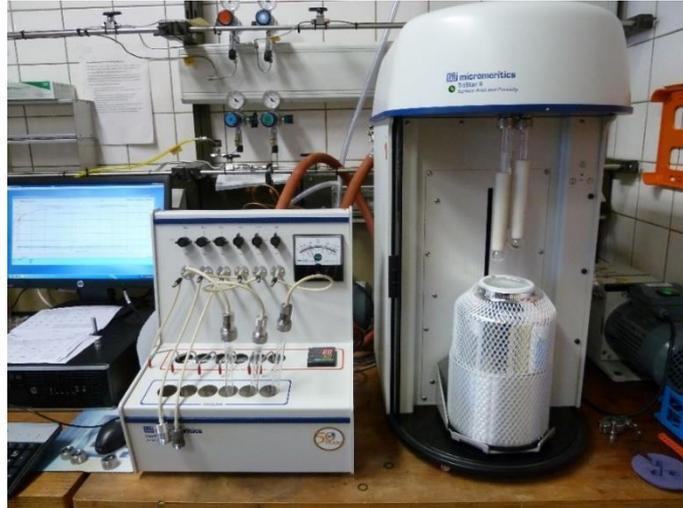
**Abbildung 4.10.1** Messapparatur zur Bestimmung der spezifischen Oberfläche mittels Tieftemperatur-Stickstoffsorption.
