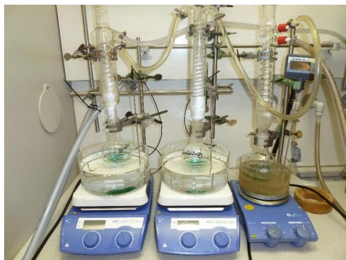
**Abbildung 4.3.1** Aufbau einer Soxhlet-Extraktions-Apparatur.
