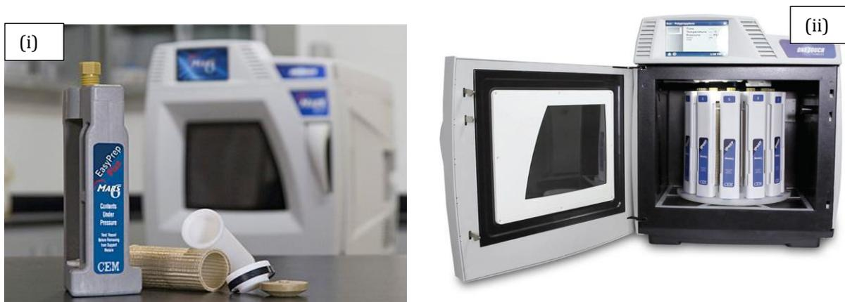
**Abbildung 4.2.2** Labormikrowelle des Typs MARS 6 der Firma CEM mit den dazugehörigen Reaktionsgefäßen.
