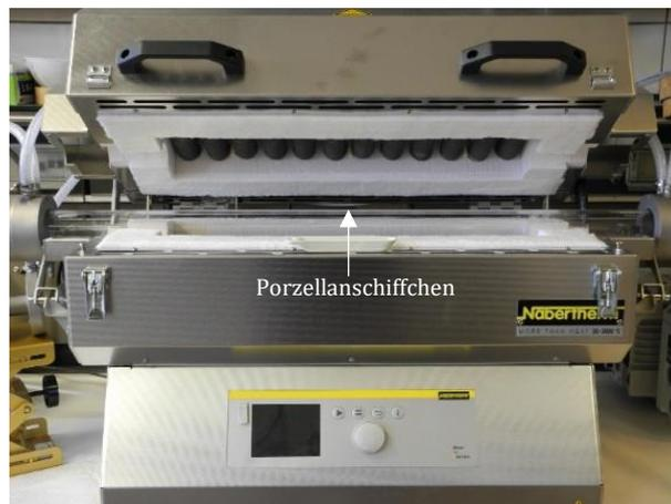
**Abbildung 4.4.2** Horizontaler Röhrenofen für die thermische Aktivierung von Hydrokohlen.
