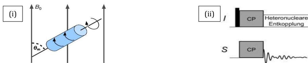
**Abbildung 3.4.2** (i) Rotor am „Magic Angle“ und (ii) klassische Pulssequenz für ein Standard CP-NMR-Experiment.<sup>[293]</sup>
