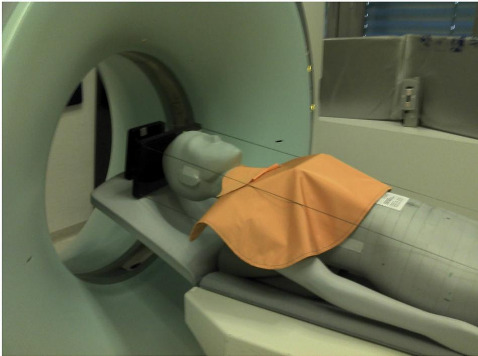
Abbildung 6.2: Mavig RP648 Protektor für Schilddrüse, Sternum, Brust und Schultergelenke mit 0,35 mm bleiäquivalentem Inlet am CIRS ATOM anthropomorphen Phantom Irene [63]
