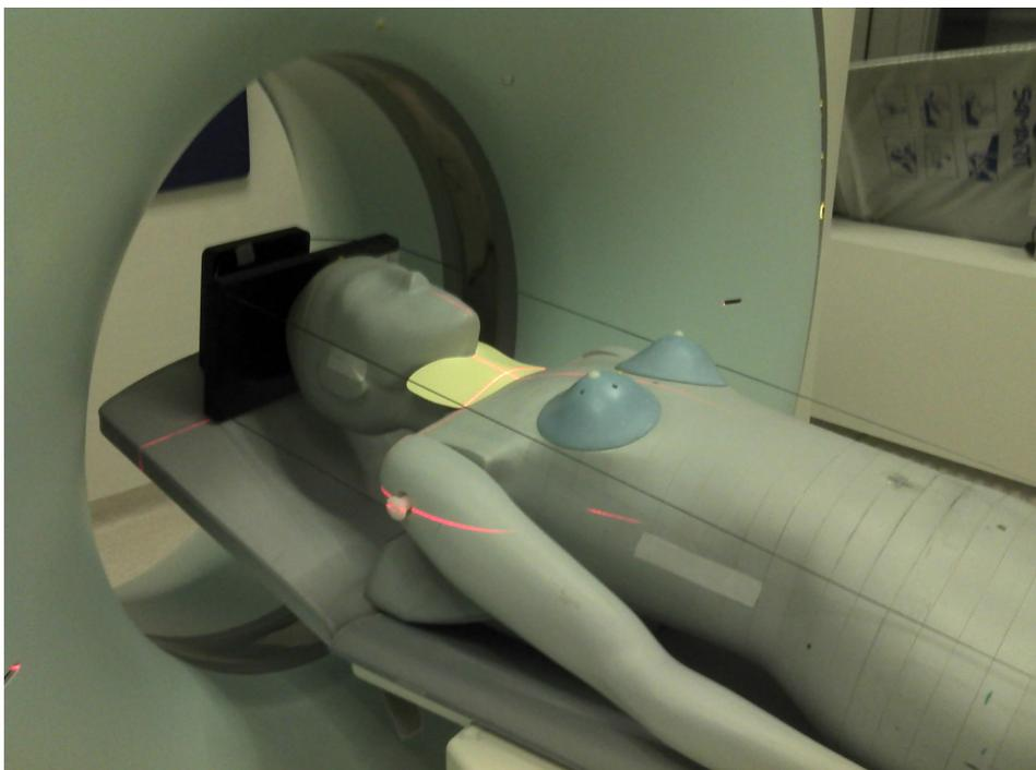
Abbildung 6.3: F & L Medical Products Thyroid Shield mit 0,06 mm Pb Äquivalent am CIRS-ATOM-Phantom.
