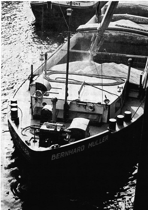
Abb. 3: Getreideumschlag mittels Saugheber an der Bremer Getreideanlage — deutlich erkennbar das Verwehen des Staubanteils
