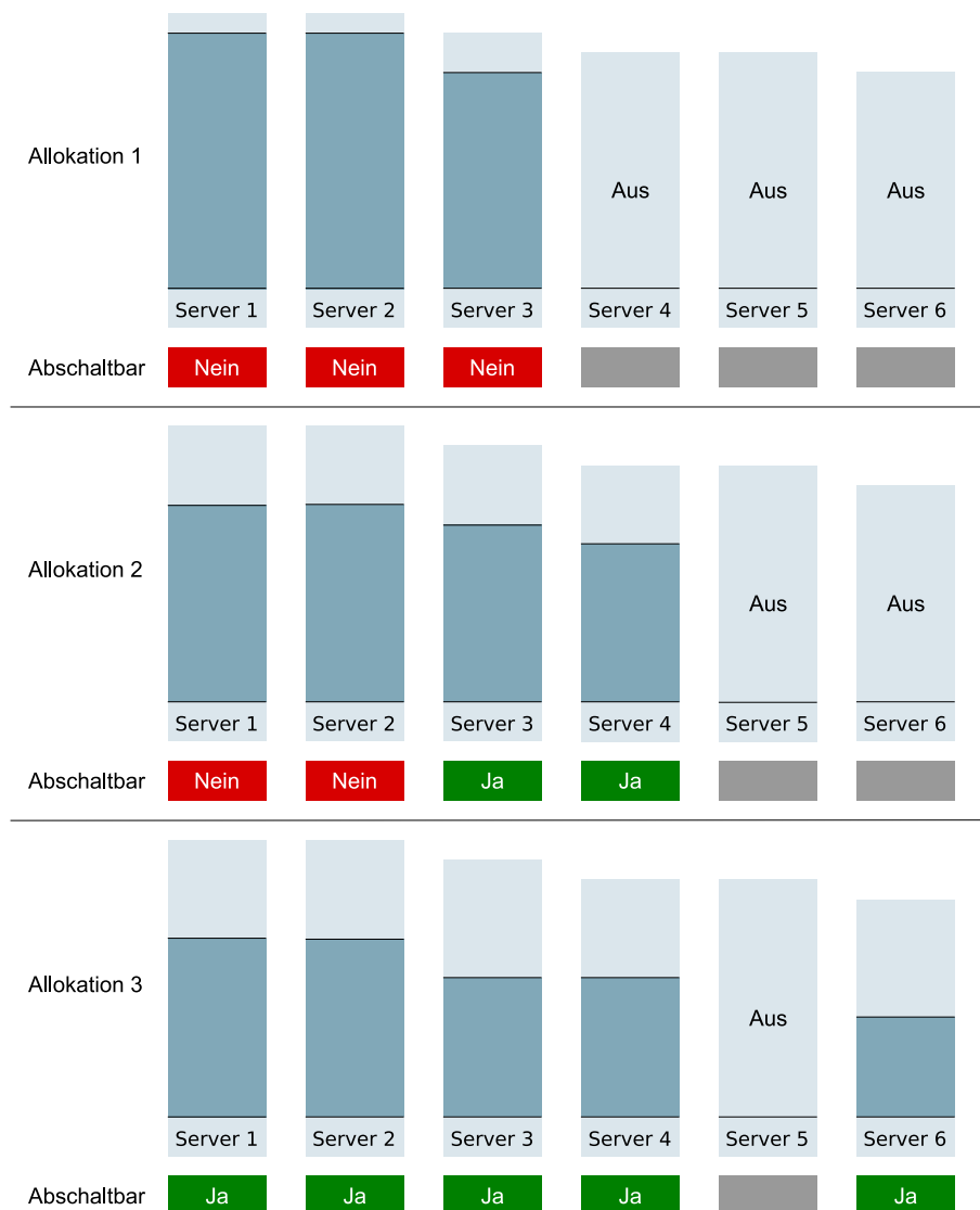
Abbildung 4.7: Die globale Flexibilität gibt die Anzahl der Server an, die ausgeschaltet werden können, ohne dass neue hinzu geschaltet werden müssen. Im gezeigten Beispiel in Allokation 1 kann keiner der Server ausgeschaltet werden, die Allokation ist minimal flexibel. In Allokation 2 wurde ein Server hinzu geschaltet und die Last verteilt, nun können zwei Server ausgeschaltet werden. Die globale Flexibilität beträgt immer noch null, da nicht mindestens ein beliebiger Server ausgeschaltet werden kann. Dies ist erst in Allokation 3 erreicht.
