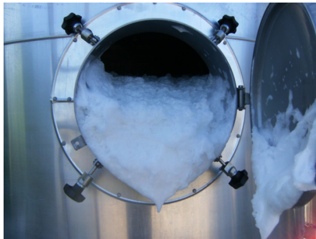
Abb. 5: Schaumbildung in einem Biogaswäscher der MT-BioMethan GmbH (Quelle: MT-BioMethan GmbH, nicht öffentlich zugänglich).
