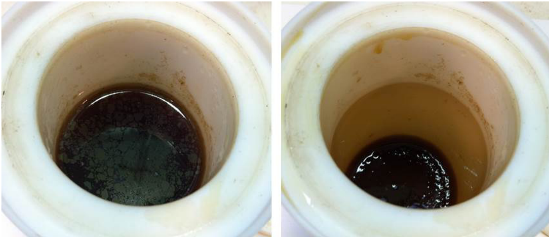
Abb. 68: Sedimentierter ölig-bräunlicher Feststoff nach 14-tägiger Alterung bei 180 °C (Lösung Y: 2,7 M MDEA + 40 Gew.-% PZ).
