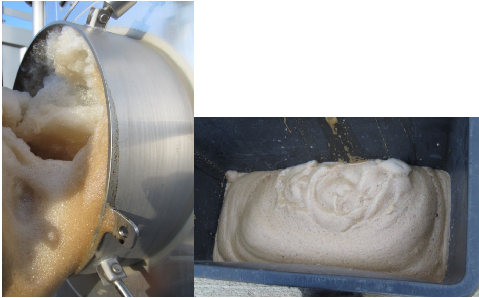
Abb. 6: Schaumbildung 2 in einem Biogaswäscher der MT-BioMethan GmbH (Quelle: MT-BioMethan GmbH, nicht öffentlich zugänglich).
