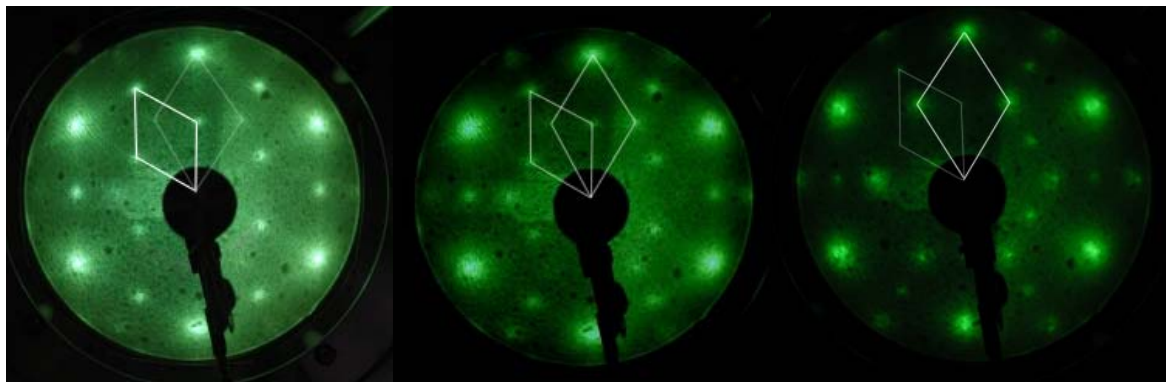
Abbildung 3.22: 3 LEED-Bilder vom Phasenübergang des \text{Fe}_3\text{O}_4(111) zum \alpha\text{-Fe}_2\text{O}_3(0001) . Zu Beginn (links) ist neben den Spots von \text{Fe}_3\text{O}_4(111) deutlich die Ausbildung eines zweiten um 90^\circ verdrehten inneren Hexagons, welches dem \alpha\text{-Fe}_2\text{O}_3(0001) zuzuschreiben ist, zu erkennen. Mit sich vollziehender Phasenumwandlung (rechts) werden die Spots des bestehenden inneren Hexagons vom \text{Fe}_3\text{O}_4 immer schwächer. Man beachte die um 60^\circ gedrehte Elementarzelle von reinem \alpha\text{-Fe}_2\text{O}_3(0001) zu der von den \alpha\text{-Fe}_2\text{O}_3(0001) -Inseln der Biphase (siehe Abb. 3.23).
