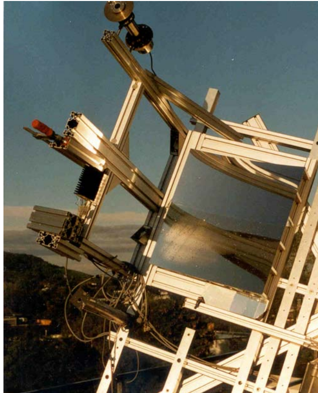
Abb. 4.1: Photographische Aufnahme des Prototyps eines Linearkonzentrators mit zweiter Stufe montiert auf eine Solarnachführung. In der Brennpunktlinie sind die Sekundärkonzentratoren zu erkennen.
