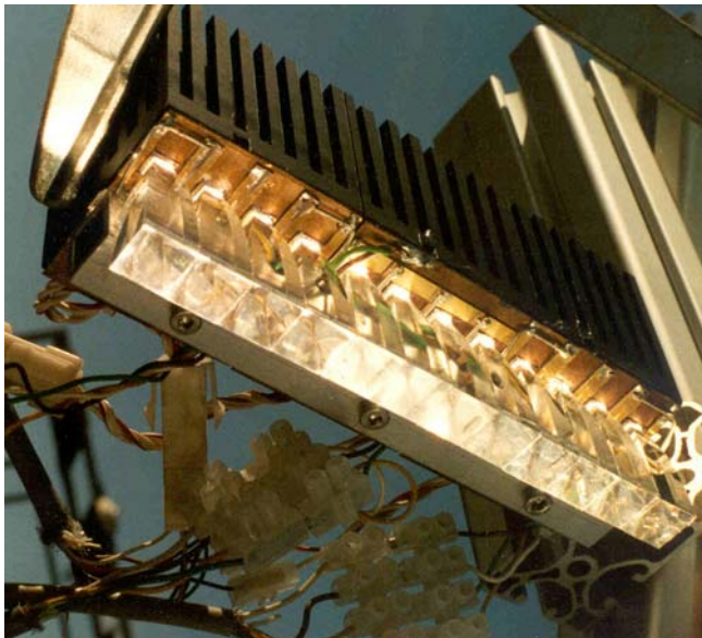
Abb. 4.2: Photographische Aufnahme des Empfängers in der Brennpunktlinie der Parabolspiegel; rechts die Verschaltung der Zellen.
