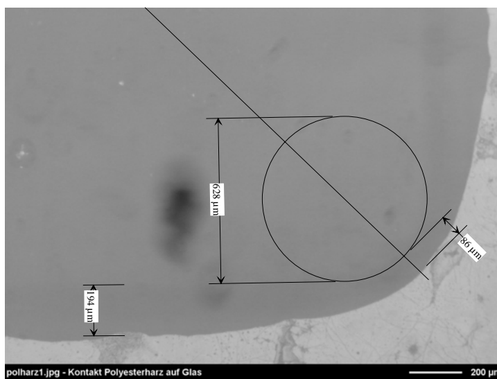
Abb. 6.5: Mikroskop-Aufnahme der Klebefläche eines CPCs aus Polyesterharz; die Umrise der CPC-Austrittsfläche sind als heller Schatten zu erkennen, der in der Ecke abgerundet ist (Radius 314 \mu\text{m} ).
