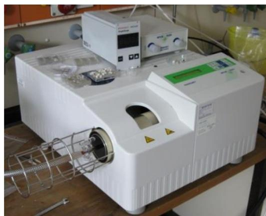
**Abbildung 6: SDTA/TG-Apparatur**
