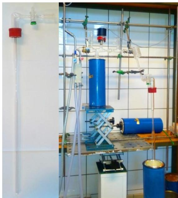
Abbildung 12: Duranglasampulle mit Quickfit (links) und Abschmelzapparatur (rechts)
