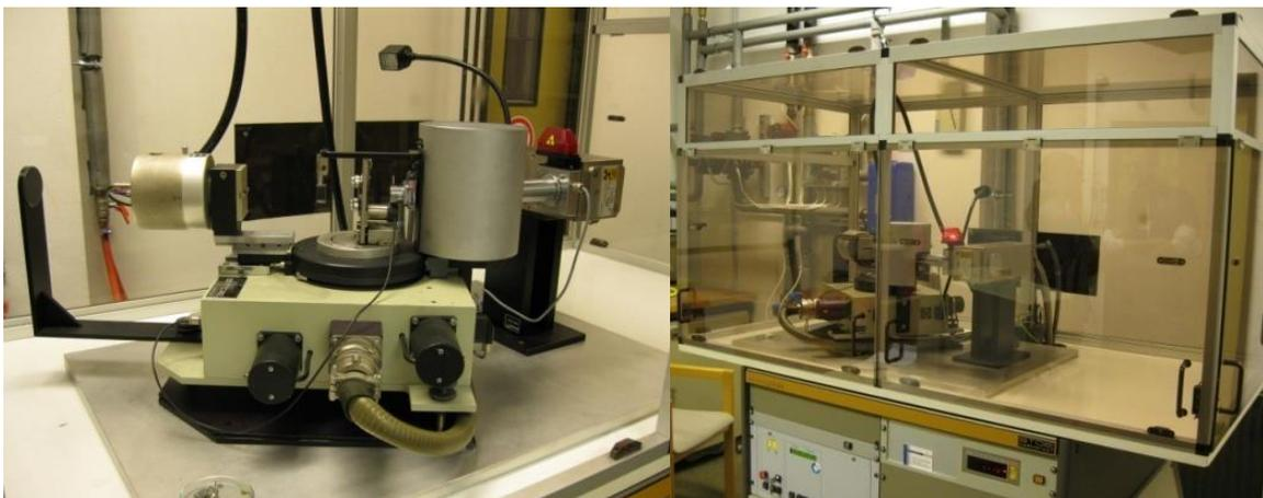
**Abbildung 5: Pulverdiffraktometer mit Transmissionsprobenträger**
