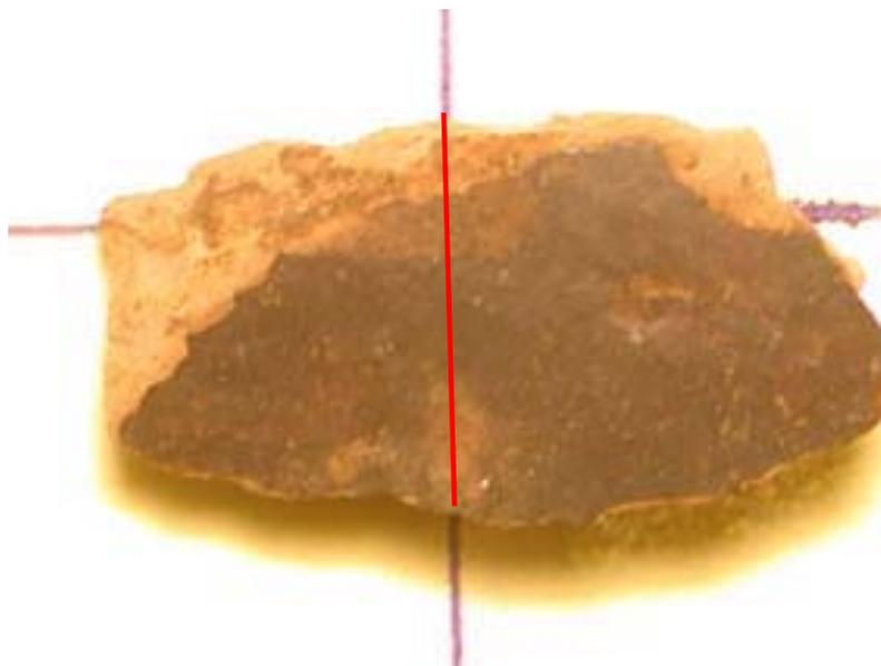
**Abb. 3.11:** Weißlichtbild eines ca.  $1,5 \times 1 \text{ cm}^2$  großen Bruchstücks, behandelt mit PEG/PU.
