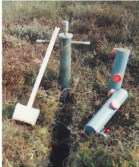
Abb. 13: Probenentnahme der Bodenmonolithen für die Laborlysimeterversuche.
