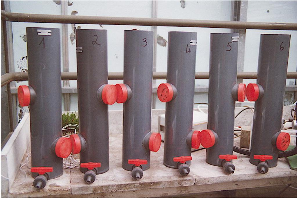
Abb. 12: Laborlysimeter
