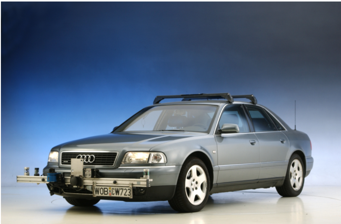
Abbildung 4.1.: Versuchsträger mit heterogener Sensorik zur Umgebungserfassung. Verschiedene Lasersysteme, ein Fernbereichsradar sowie eine Mono-Bildverarbeitung (Kamera befindet sich vor dem Innen Spiegel) kommen zum Einsatz.
