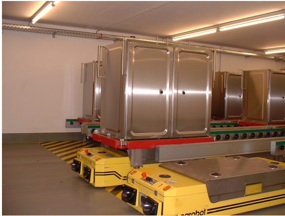
(a) FTF als Unterfahrschlepper (Quelle: Joerg Hammes)
