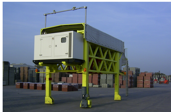
(b) Outdoor FTF zum Transport von Betonsteinen (Quelle: Betonsteinwerk Lintel)
