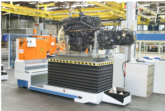
(a) FTF als mobile Montageplattform (Quelle: Fa. Bleichert)
