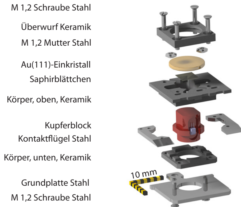
Abbildung 3.7: Explosionszeichnung des Einkristallhalters, 1. Version, [60].
