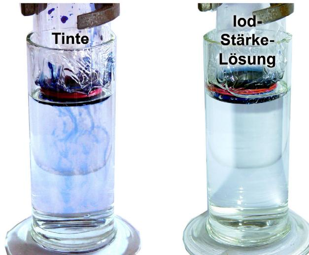
**Abb. 5.7: "Molekulares Sieben" von Tinte und Iod-Stärke-Komplexlösung**
