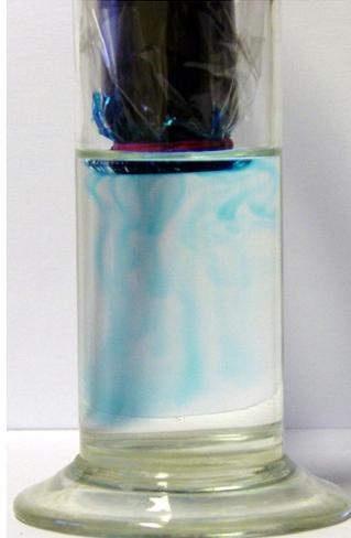
**Abb. 12.3:** „Molekulares Sieben“ von Patentblau-V-Lösung
