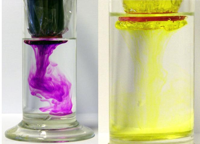
**Abb. 12.2:** „Molekulares Sieben“ von Kaliumpermanganat-Lösung (links) und Kaliumchromat-Lösung(rechts)
