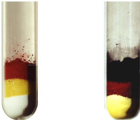
**Abb. 8.6:** Die Deutschlandflagge aus Kupfer(I)-oxid, Kaliumchromat und Zinkoxid. Links im kalten, rechts im heißen Zustand.
