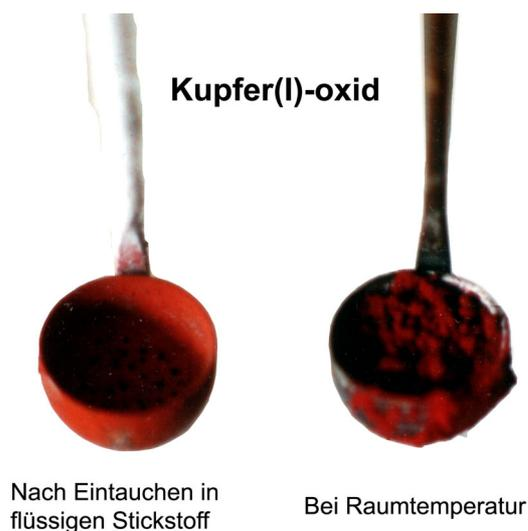
**Abb. 8.4:** Vergleich der Farbe von Kupfer(I)-oxid bei niedrigen Temperaturen und bei Raumtemperatur
