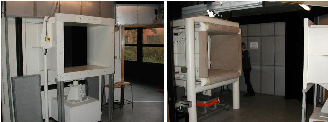
Abbildung 5.1: Windkanal der Carl-von-Ossietzky Universität Oldenburg. Links: Aufnahme der auf einem Punkt gelagerten Austrittsdüse. Rechts: Aufnahme der zur Verfügung stehenden Messstrecke.
